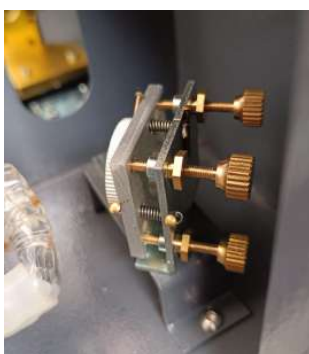
Primer espejo cerca del tubo láser de 50W.(No.1)
