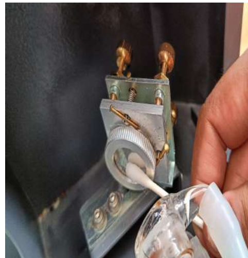
Primer espejo cerca del tubo láser de 50W.
