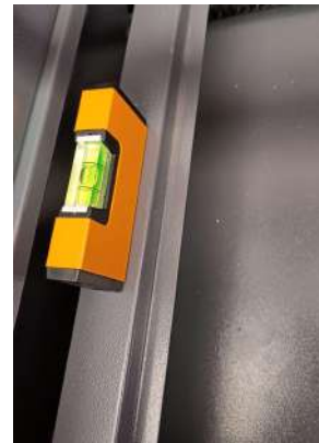
Coloca el nivel en el eje "Y" de la cama
