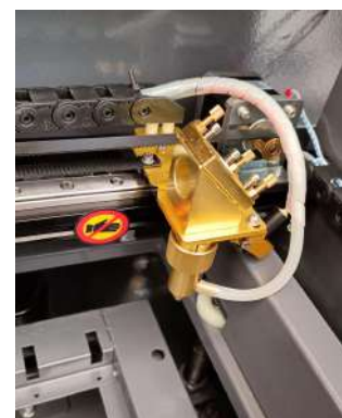
Tercer espejo localizado en la boquilla.(No.3)
